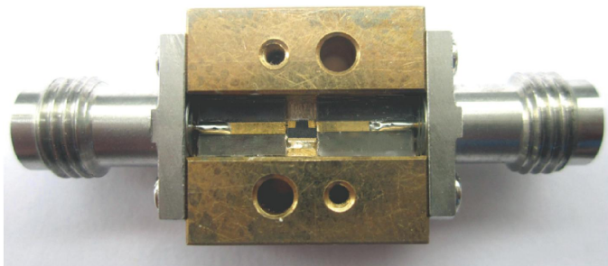
DC-18GHz WB1 系列测试治具(用于金电极)
